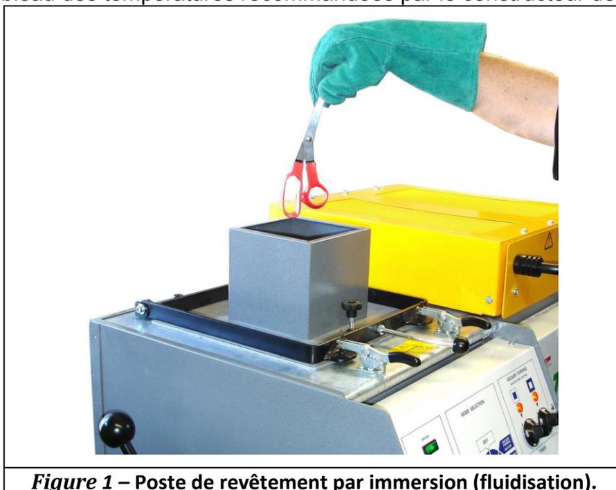
**Figure 1 – Poste de revêtement par immersion (fluidisation).**
