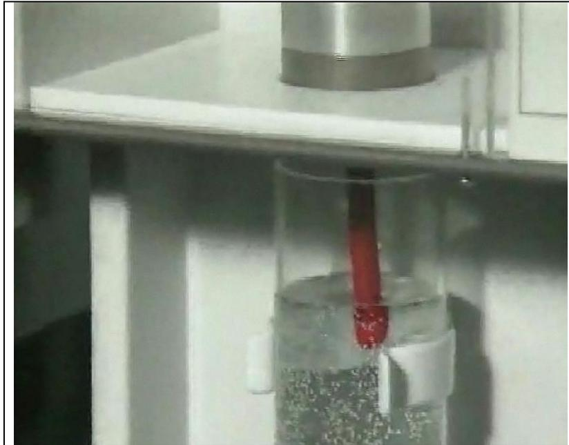
*Figure 3 – Exemple de pièce extrudée sur le centre de thermoformage : Profilé en I.*
