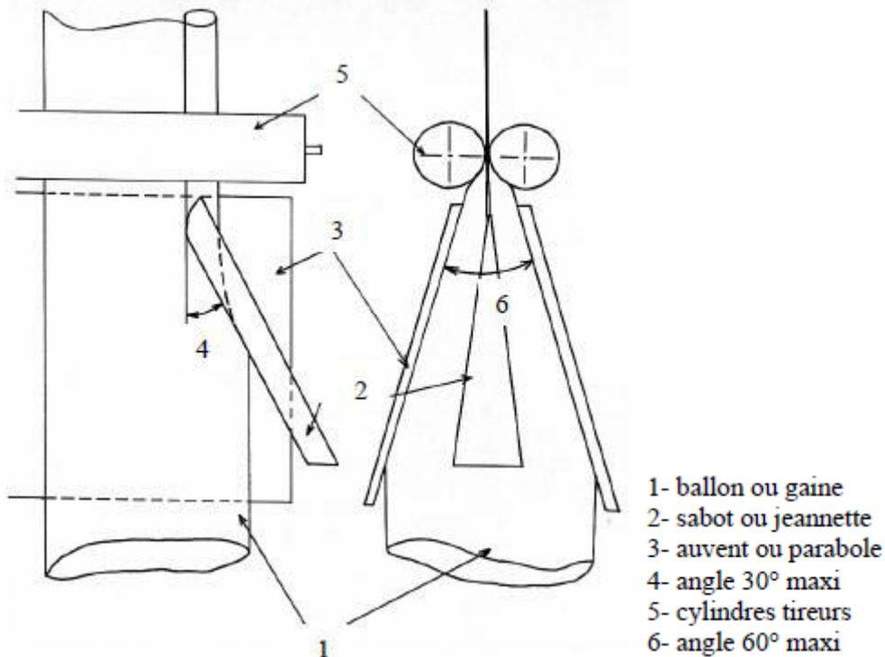
6. il est nécessaire de faire une mise à plat progressive de la gaine **afin d'éviter les plis**.
