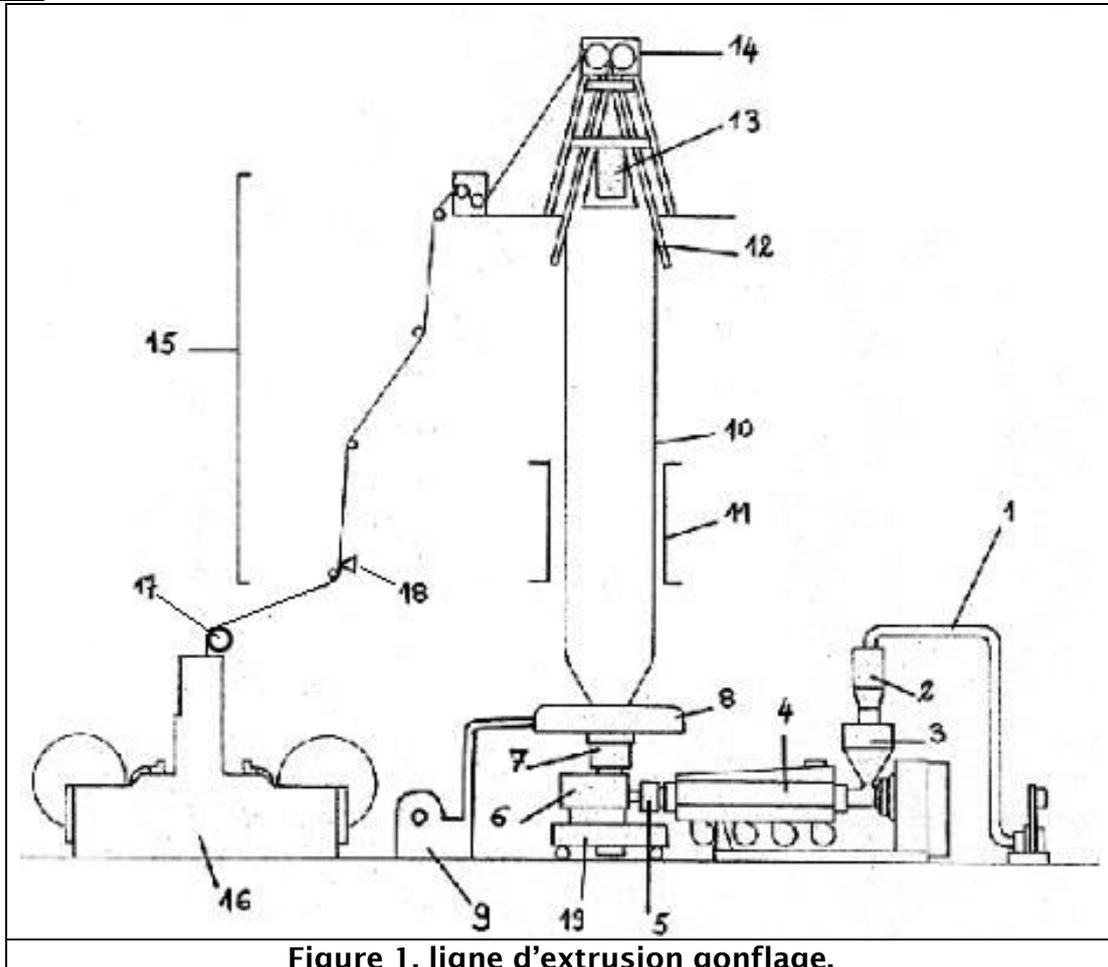
Figure 1. ligne d'extrusion gonflage.
