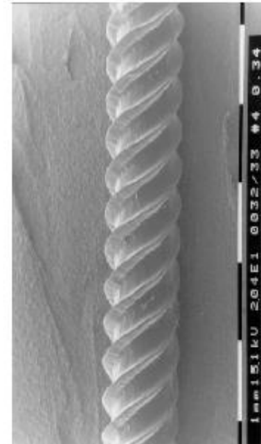
(d) fissures hélicoïdales
