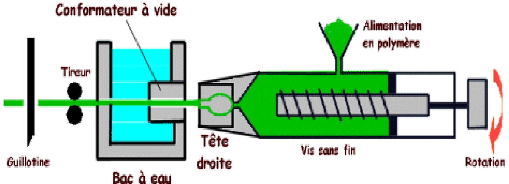
Figure 1. Ligne d'extrusion.
