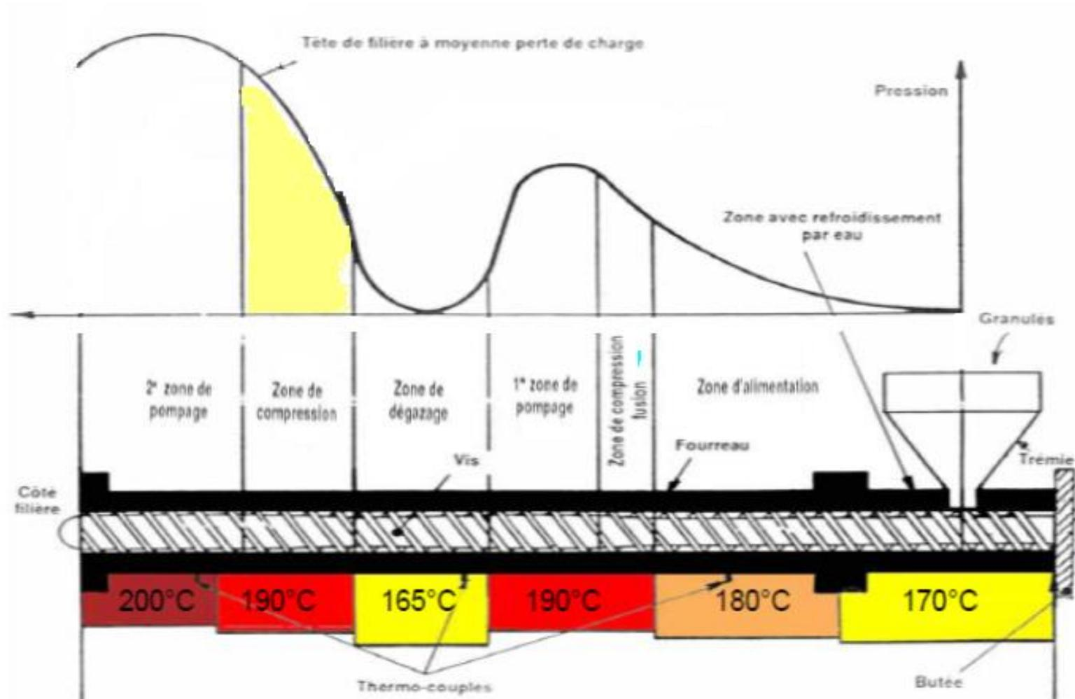
*Vue en coupe de la vis et du fourreau (profil de température et de pression)*
