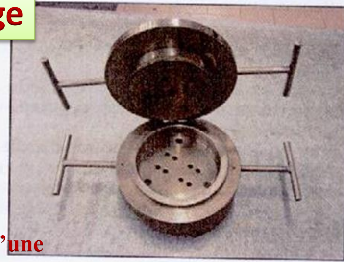
Piston sur le couvercle et buses dans le pot
