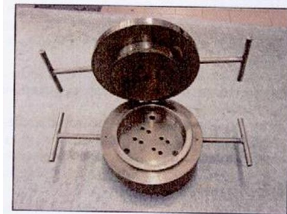
Piston sur le couvercle et buses dans le pot
