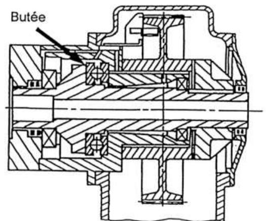
1. Quelle force supporte la butée installée sur cette extrudeuse (en tonnes) ?
