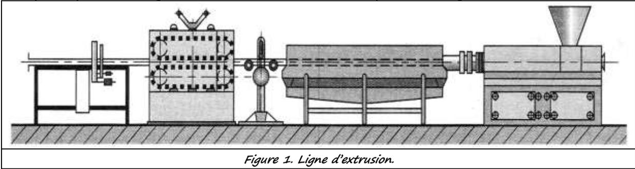
Figure 1. Ligne d'extrusion.
