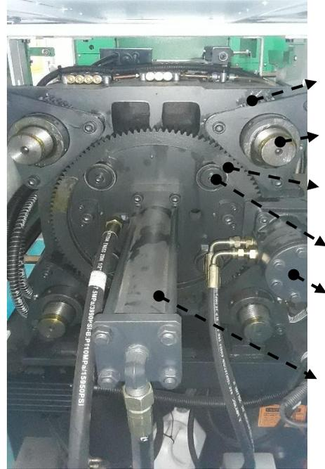
26. Compléter le branchement par les flexibles et tuyaux de la presse avec ses périphériques (refroidisseur, thermorégulateur, débitmètre (**circuit froid en bleu, circuit chaud en rouge**)) ;
